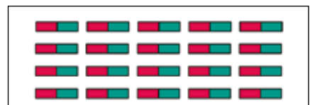
magnetisches Metall mit Nord- und Südpol
